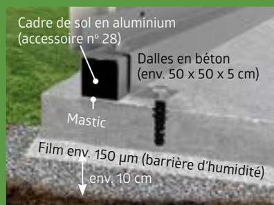
Poser des dalles en béton sur un lit de gravier est une solution plus économique. Nous recommandons vivement l'utilisation du **cadre de sol en aluminium**.
